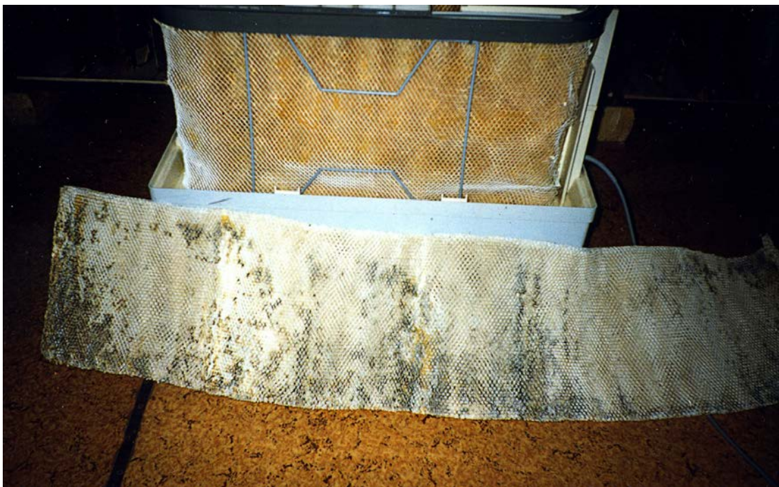
Рисунок 3.4 – Фильтры после прививки биоцида через год эксплуатации и до биоцидной защиты (рядом с музейным увлажнителем)
