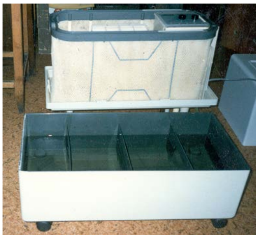
Рисунок 3.2 – Музейный увлажнитель в разобранном виде: ванна с водой, и внутренняя рама-держатель бумажного полотна
