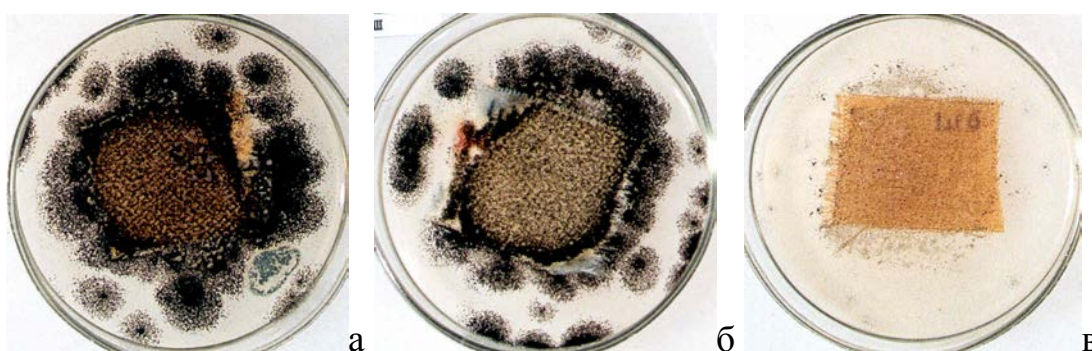
Рисунок 5.21 – Развитие Aspergillus niger на образцах шерсти: а – контроль, б - AgБион-1, в - AgБион-2 (метод агаровых сеток)
